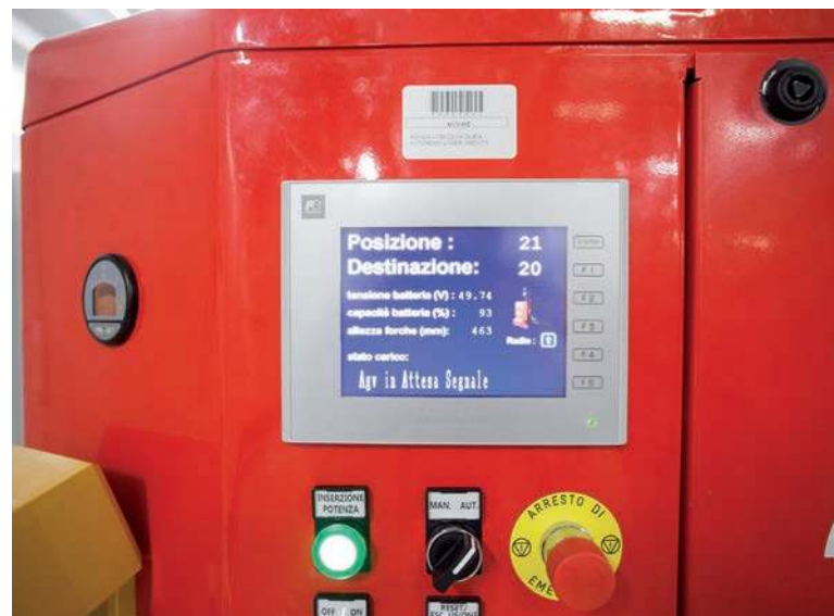
Easystor, dialogando con i pallettizzatori e con SAP, tiene traccia lungo tutto il processo delle informazioni di provenienza dei pallet e coordina le missioni degli AGV
