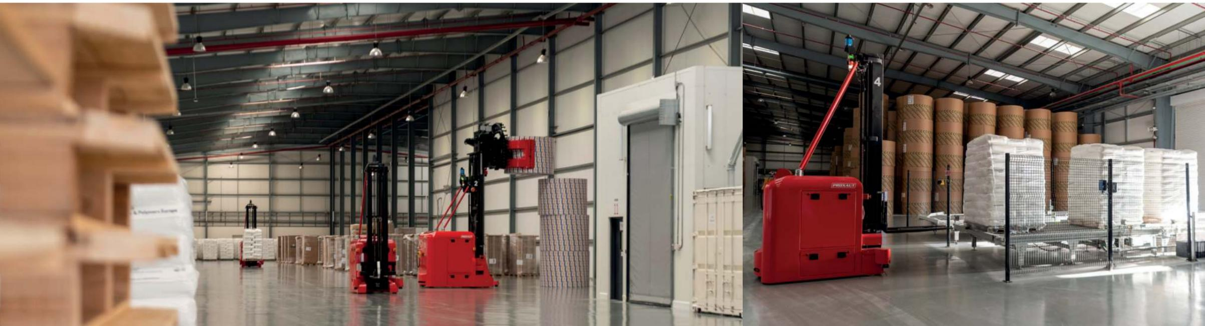
La gama productiva de Proxaut parte de las carretillas serie CH que se ocupan de la tarea de tomar y depositar las mercancías que hay que manipular, sustituyendo la carretilla elevadora tradicional. Los vehículos pueden equiparse con grupos de levantamiento con posiciones de toma y depósito variables además de los estabilizadores de carga superiores o laterales que permiten la manipulación de cualquier tipo de producto y que pueden entregarse como accesorios al equipamiento estándar.
